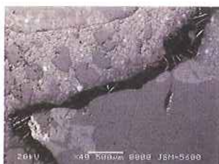
La "backscattered electron image" (BEI) mostra la crescita cristallina all'interno della microfessurazione ingrandita (campioni di carote provenienti dalle strutture interrate del Terminal 3 del nuovo aeroporto di Singapore, 150.000 m 3 di calcestruzzo trattato con il Penetron ® Admix)
